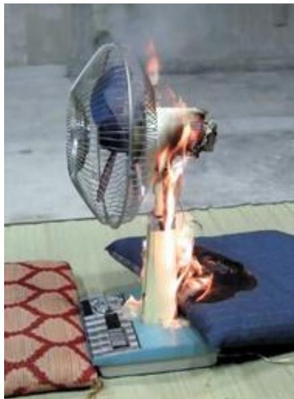
長期使用の扇風機で火災事故が発生しています。シリーズ②で07年度の発生件数を照会しました。その後08年、09年と減少傾向ですが、相変わらず電気製品のワーストクラスです。主たる原因是、進相用コンデンサが古いものは、ペーパー式であったため、経年劣化で過熱・発火に至るものです。モータカバーが金属からプラスチックになって、火災拡大するようになったのですが、当時の設計者や品証マンも、夢のまた夢であったはずです。最近のコンデンサはフィルム式に進化し、その危険はありません。一般的に15年前位のものは危険、20年になると非常に危険です。思い切って処分・買換えして、内需拡大にご協力しましょう。(換気扇も同様ペーパーコンを使用していました)
